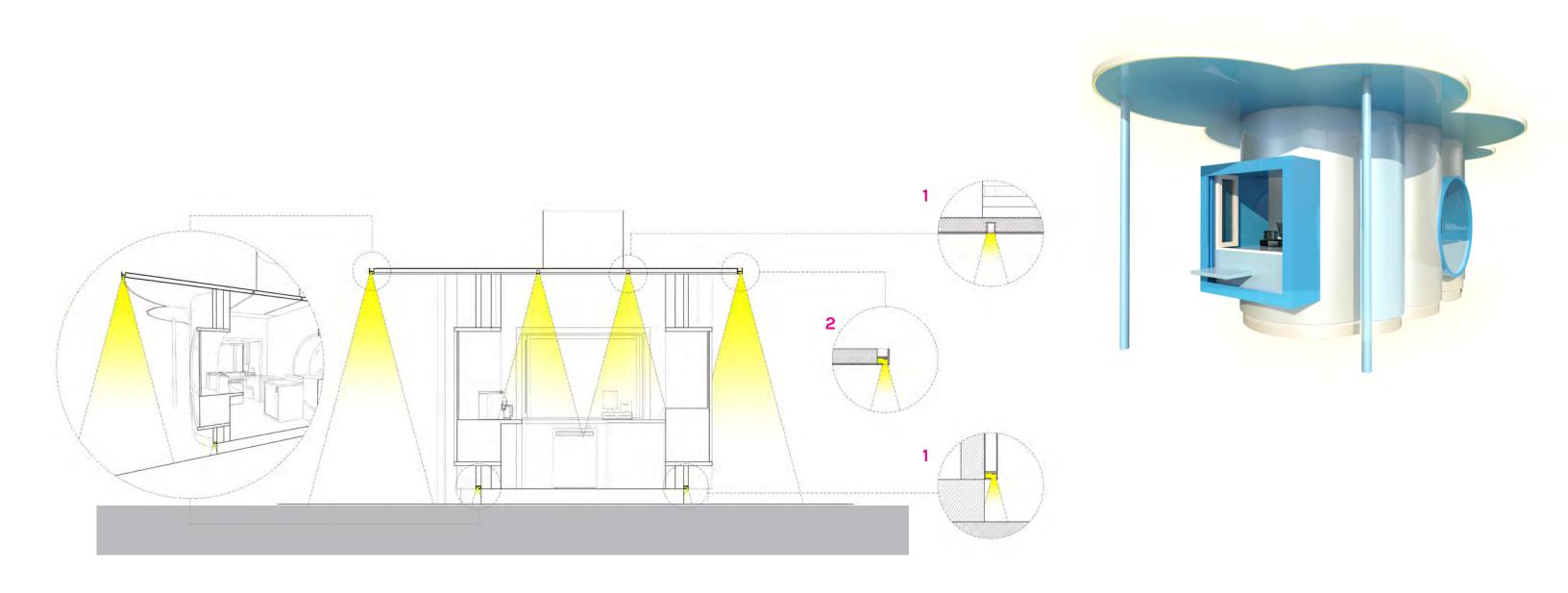
1 FLEXIBLE LED STRIP LIGHT (EXTERIOR) 2 LED LINEAR FIXTURE (INTERIOR)
